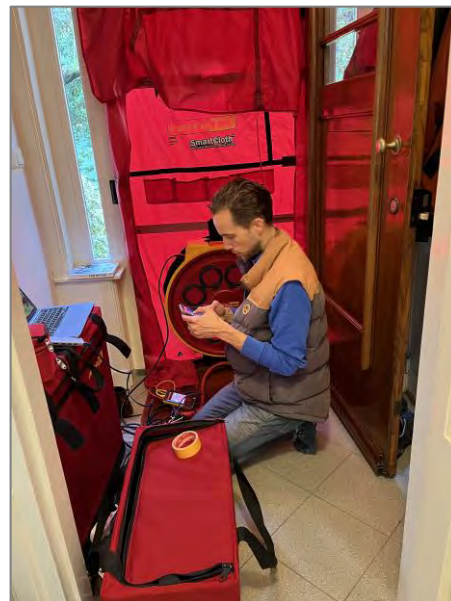
Blowerdoortest door Verduurzaamwoning
